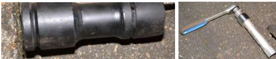
Afbeelding 18 Verlengde dop 32 en ratel met pijpsleutel 30/32 (R)
