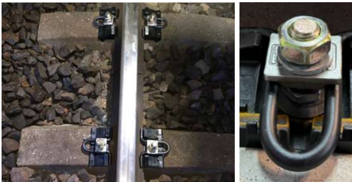
Afbeelding 19 ShimLift S op NS90. Rechts: detail klem met moer en borgring
