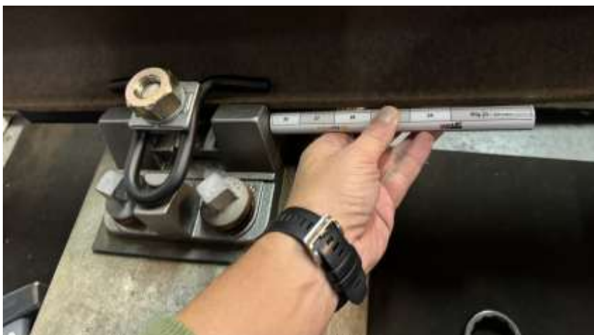
Afbeelding 8 Maatlat voor de positiebepaling van de vulwiggen
