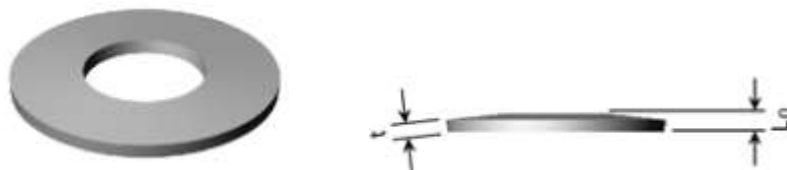
Afbeelding 17 Schotelveer: bolle zijde boven!
