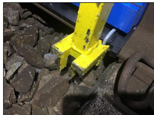
Figuur 13: Veerklem in de eindpositie
